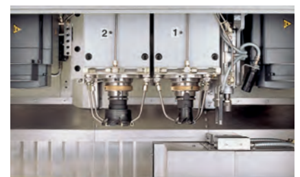
Zwei unabhängig voneinander laufende Präzisionsfrässpindeln können mit Werkzeugen für unterschiedliche Materialqualitäten ausgestattet werden.
