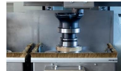
Die Proben werden von unten gefräst, wodurch ein extrem schnelles Proben-Handling gewährleistet wird.
