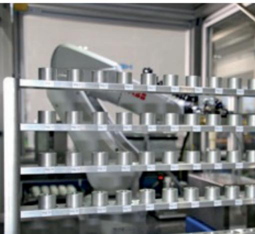
Das CNSLab übernimmt den kompletten Ablauf der Probenvorbereitung vom automatischen Probenempfang bis zur Übergabe des vorgeglühten Tiegels mit gewogener Probe und Zusätzen an das Analysegerät. Außerdem unterstützt das CNSLab alle Schritte, die für die Kalibration der Analysegeräte notwendig sind einschließlich Verwaltung der Referenzproben und Festlegen des Kalibrationsplans.
