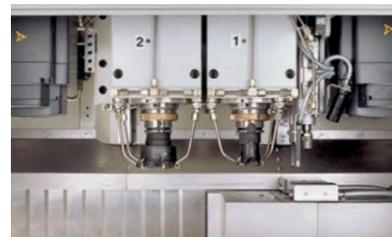
Zwei unabhängig voneinander laufende Präzisionsfrässpindeln können mit Werkzeugen für unterschiedliche Materialqualitäten ausgestattet werden.
