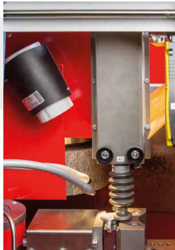
Messeinrichtung zur Erkennung der Schleiftopfabnutzung
