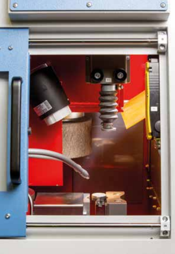
HTS 2000 mit hydropneumatischer Spannvorrichtung
