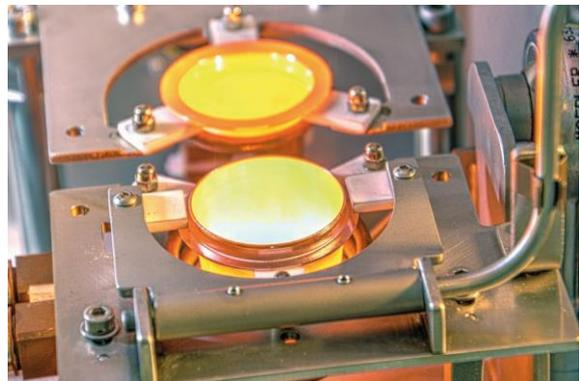
Gleichzeitiges Aufheizen von Tiegel und Schale
