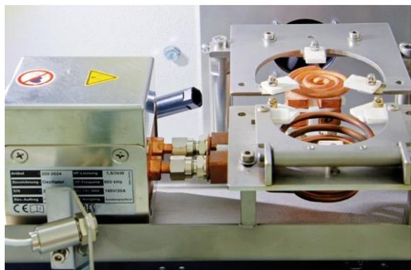
Aufschlusseinheit mit getrennten Pyrometern für Tiegel und Schale (optional)
