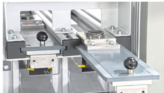
Eingabepositionen für Produktionsproben
