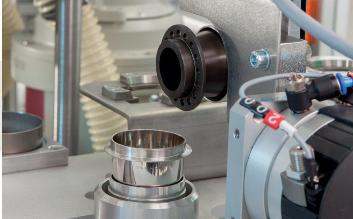
Dosierung Probenmaterial in Tiegel
