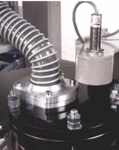
Die automatischen Entleerungs- und Reinigungsmechanismen der Mahlgefäße ermöglichen die sequentielle Verarbeitung unterschiedlicher Materialien.
