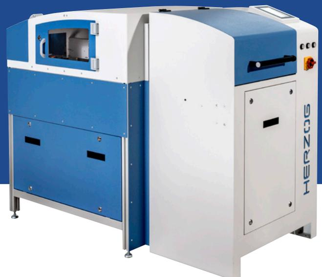
HP-PKM mit Magazin zum automatischen Be- und Entladen der Mahlgefäße
