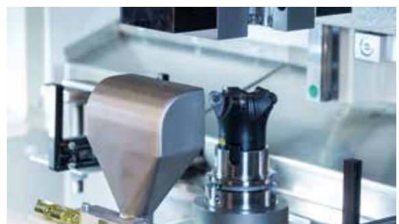
Automatische Späneauffangvorrichtung für die Verbrennungsanalyse
