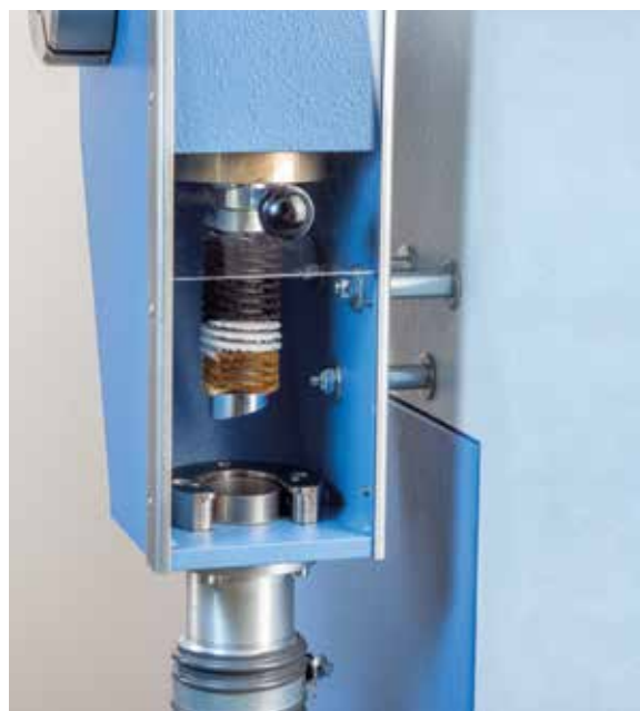
Reinigungsgerät für Stahlringe, manuelle Ausführung (Option)
