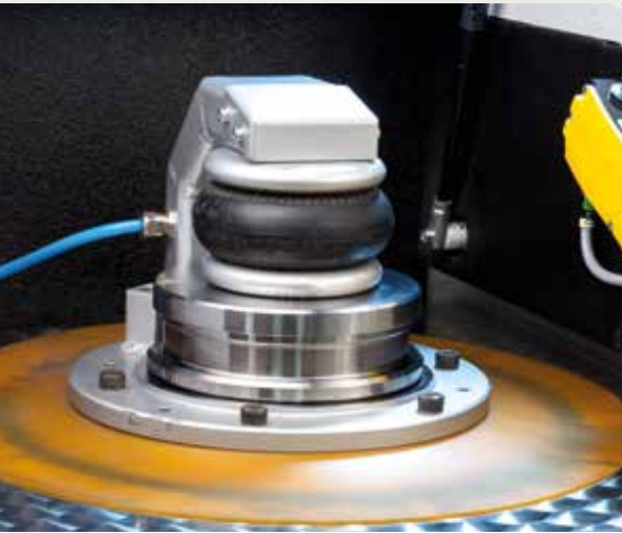
HSM 100 P mit pneumatischer Spanneinrichtung (Option)
