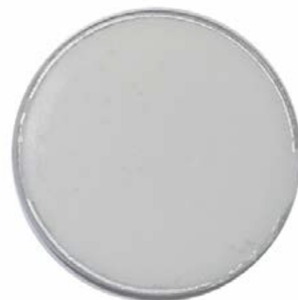
Comprimé, obtenu par pressage dans une coque en aluminium
