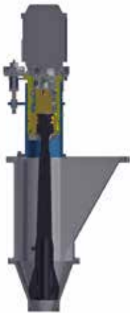
Structure générale du concasseur à cônes
